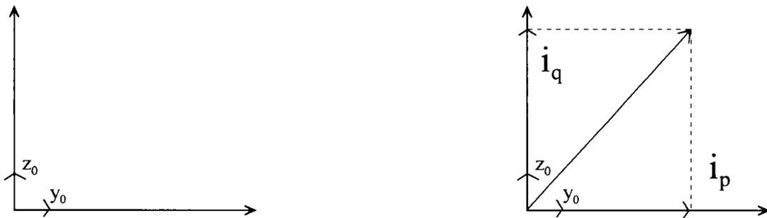
**Figura 3.** Diagrama vectorial para la descomposición del vector intensidad en sistemas trifásicos que no incluyan componentes de secuencia cero de tensión e intensidad.
