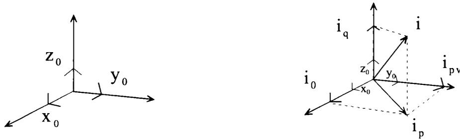
**Figura 5.** Diagrama vectorial de la descomposición del vector intensidad en un sistema trifásico que incluye componentes de secuencia cero.
